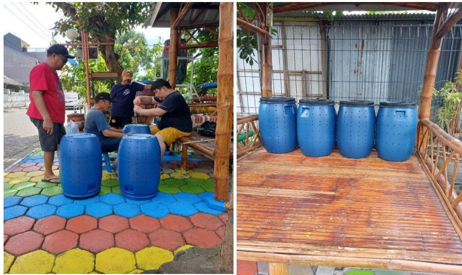
Gambar 3. Hasil pelubangan drum PVC komposter 60 liter (Sumber: Tim abdimas, 2026)
